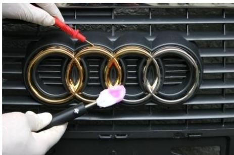
После активации, тщательно сполоснув поверхность дистиллированной или де-ионизированной водой, приступаем к процессу золочения.
