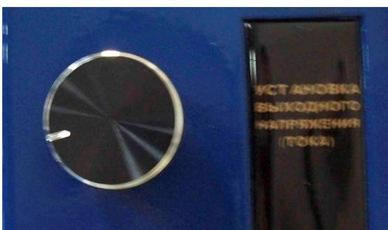
Используя регулятор выходного напряжения можно устанавливать на анодном выходе требуемое выходное напряжение, необходимое для нанесения методом электрохимической металлизации того или иного металлического покрытия.
