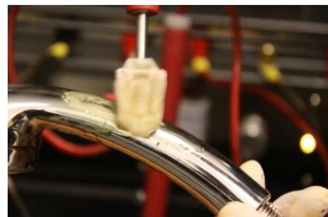
Неправильное положение тампона (касание “плоскостью” или верхней частью тампона) при подготовке поверхности
