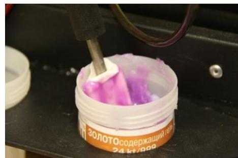
В процессе нанесения покрытия, проводите по поверхности детали только “бородкой” тампона, стараясь сохранять одно и то же расстояние до поверхности детали.
