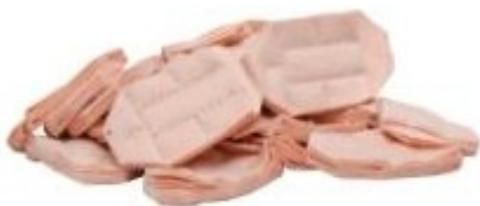
Тампоны, используемые для нанесения металлопокрытия, сшиты из хорошо пропитываемой трикотажной ткани. Тампоны используются для подготовки поверхности перед проведением процесса металлопокрытия и для нанесения металлического покрытия методом электронатирания.
