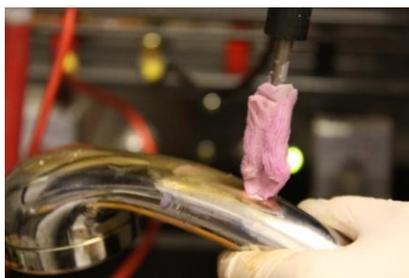
Неправильное положение тампона (касание верхней частью тампона) при золочении поверхности
