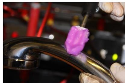
Неправильное положение тампона (касание “плоскостью” тампона) при золочении поверхности
