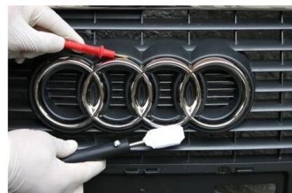
проведения активации, используя распылитель, тщательно споласкиваем поверхность детали дистиллированной или де-ионизированной водой.
